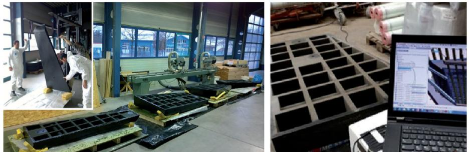
Bild 20. Vorgehensweise zum Infiltrieren des Epoxidharzes in die gedruckten Sonderschalungselemente
