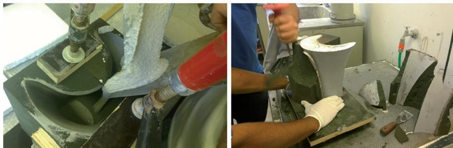
Bild 17. Konzeptionelles 3D-Modell der parabolischen Betonsäule (oben), gedruckte Sandformen (Mitte links und rechts), Beton und Schalung entfernen (unten) und fertiggestelltes Element (Mitte des mittleren Bildes)
