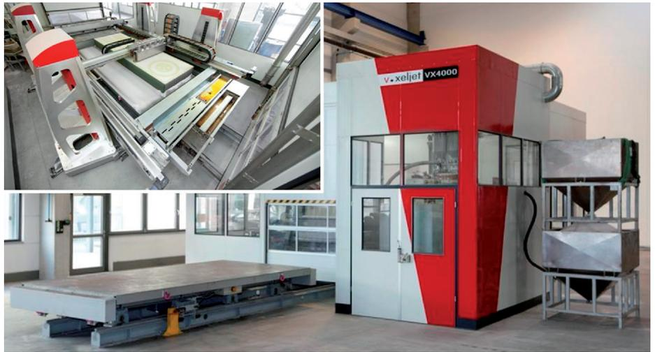
Bild 12. Automatisierte 3D-Druckmaschine VX 4000 [1]
