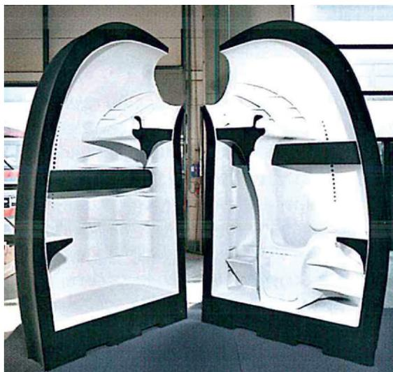
Bild 11. Als Sandmodell gedrucktes „Micro home“ [1]
