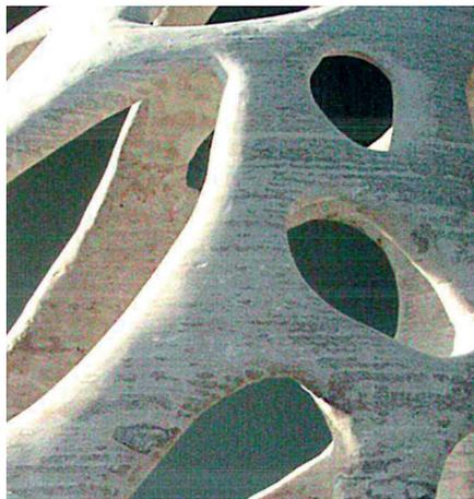
Bild 9. 3D-gedrucktes Architekturobjekt aus Pulvergemisch mit anorganischem Verfestiger [1]
