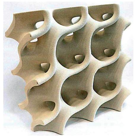
Bild 10. Hybride, aus Sand gedruckte Gussform für Fassadenpaneele aus Beton [1]
