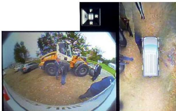
Bild 13. Monitoransicht eines 360°-KMS [14]
