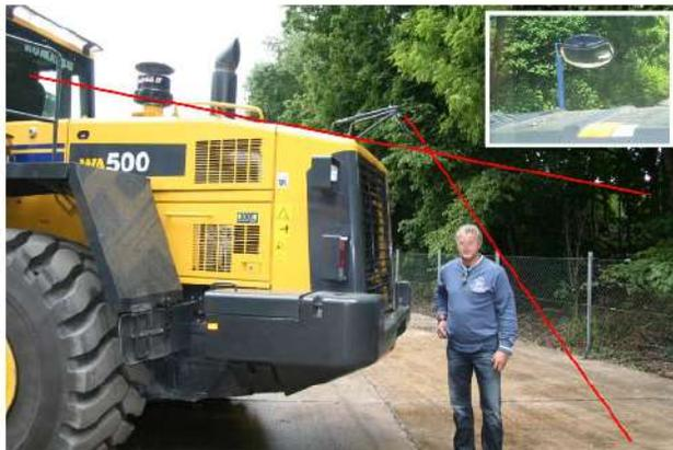
Bild 11. Toter Winkel im Heck einer Baumaschine [14]
