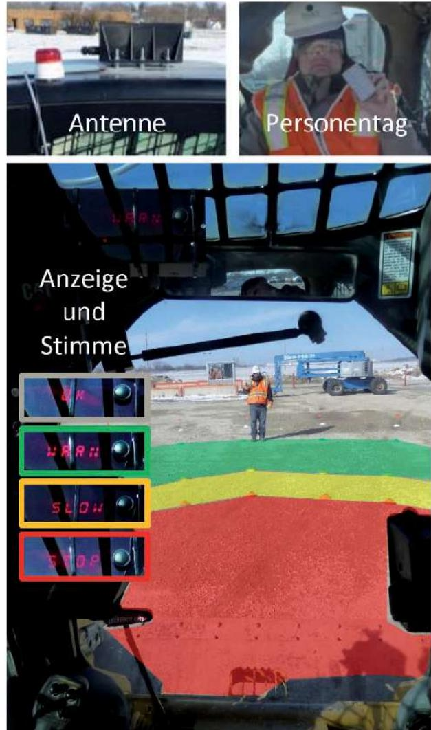
Bild 16. Magnetfeldantennenposition auf dem Dach einer Baumaschine, Personen-Tag angebracht an der PSA und drei Alarmzonen angezeigt innerhalb der Führerkabine [23]
